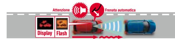
3. Applica automaticamente il freno se il rischio di collisione aumenta.
